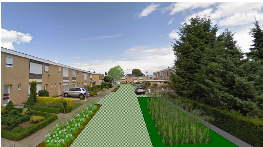
Figuur 20. Voorbeeld van hoe in een doodlopende woonwijkstraat sterk kan worden ingezet op ontharding en infiltratie d.m.v. o.a. halfverharding (bv. betonnen grasdallen), wadi's en infiltrerende plantvakken.
