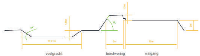
Dwarsdoorsnede stadsomwalling Herentals Le Poivre (bron: Ric Janssens - Universiteit Antwerpen)
