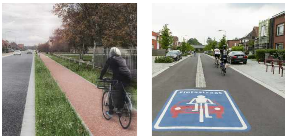
Figuur 13: vrijliggend fietspad (links), fietsstraat (rechts)
